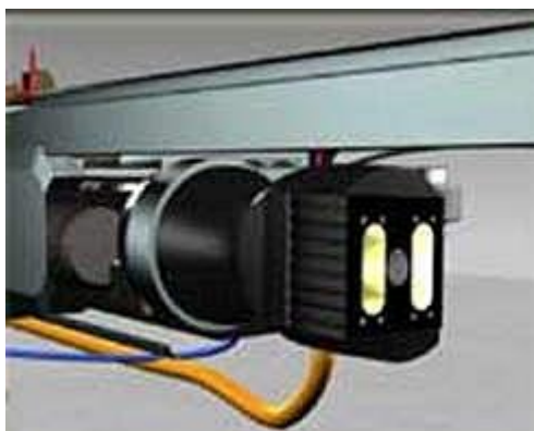
Krok 5D Kamera z przodu pokazuje operatorowi robota drogę przed nim.
