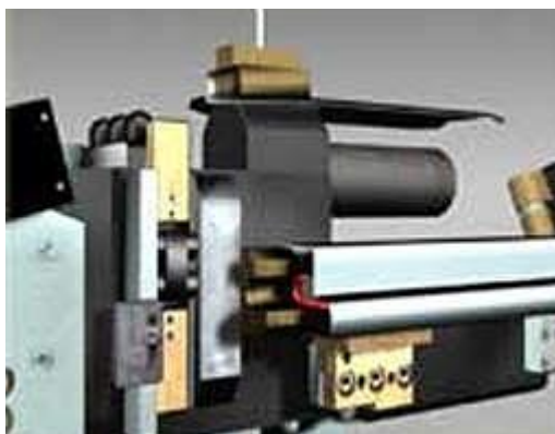
Krok 5C Robot przytwierdza kabel specjalnie zaprojektowanymi uchwytami do górnej części kanału.
